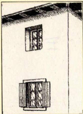
In questo caso le facciate sono intonacate con malta fina tirata a liscio. E' da rilevare che le facciate intonacate in questo modo sono anche tinteggiate con pittura di calce.
